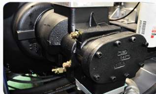
컴프레서(GHH CF 75G) 공기량 5.7m³/min
